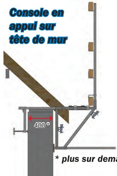
**Console en appui sur tête de mur**
