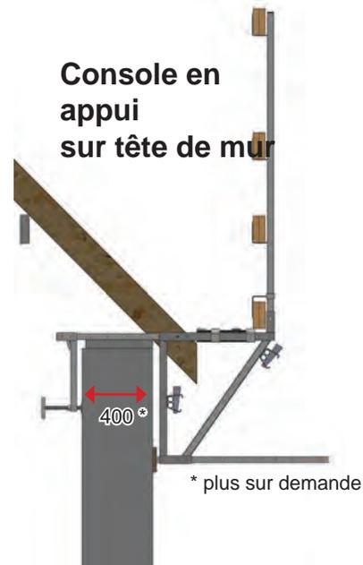
Console en appui sur tête de mur
